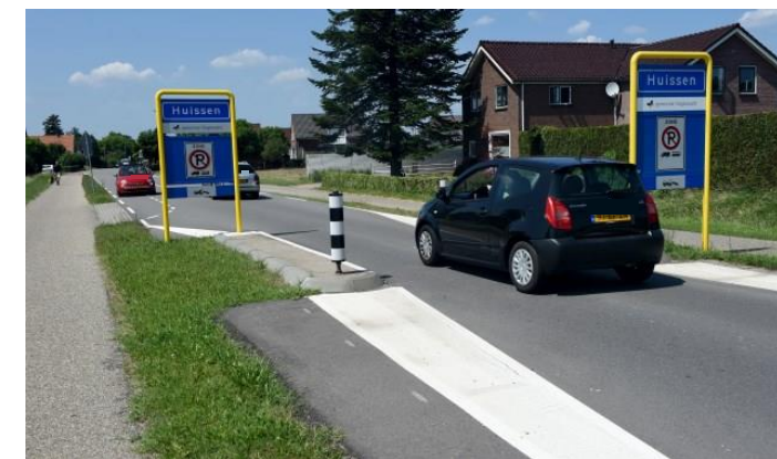
Voorbeeld van een poortconstructie/versmalling
